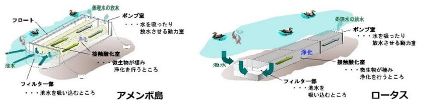
ポリスチレンというプラスチックできている“ヤクルト容器”の底を切り抜いたものを接触酸化ろ材として使用し、その表面に発生した微生物(生物膜)が汚れを分解して浄化した処理水を放出して、池の水を循環させています。停滞している水域に好気性の微生物を増殖させ活性化することによって浄化します。
